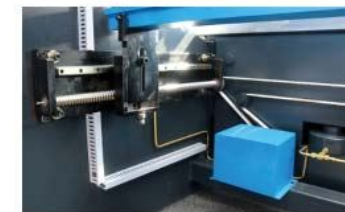
高精度后挡料 High precision backgauge
